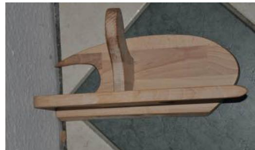
Jetzt erst wird zusammengeschraubt. Dafür müssen die Bohrungen noch in die Füße weitergeführt werden. Einfach mit dem 2-mm-Bohrer bis zum Anschlag bohren. Wenn Ihr sauber gearbeitet und vor allem gerade gebohrt habt, bleibt die Bohrung in der Mitte des Brettes. ;). Die Schrauben werden eingeschraubt und die Köpfe in den erweiterten Bohrungen versenkt.
