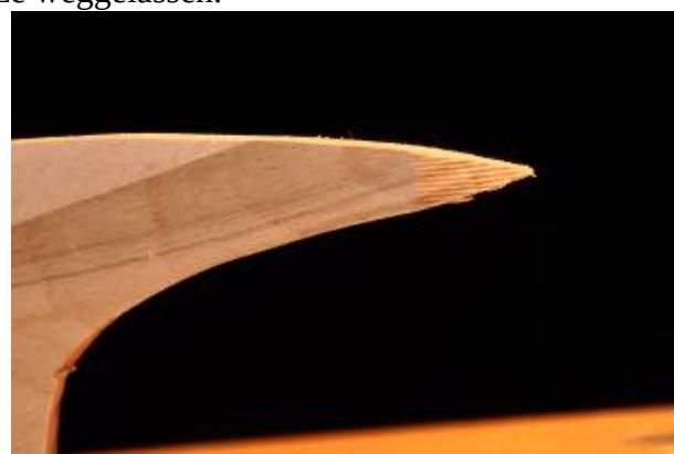
Die Spitzen werden mit der Raspel und der Feile geformt.
