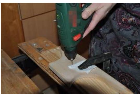
Der kleine Fuß wird mittig auf dem großen Fuß befestigt. Hier reicht eine Schraube. Die Bohrungen der beiden großen Teile müssen gemacht werden, bevor die Bohrung für den kleinen Fuß festgelegt werden kann.
