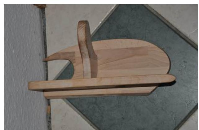
Der kleine Fuß wird auch mit einer Schraube von der Oberseite aus befestigt. Um diese Bohrung zu markieren, stellt Ihr den großen Fuß an der markierten Position auf und den kleinen im rechten Winkel dazu. Er muss direkt auf dem Bohrloch im großen Fuß sitzen. Dann wird seine Position auf beiden großen Teilen markiert und das Bohrloch auf dem Oberteil angezeichnet und gebohrt.
