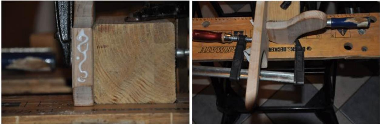
Zuerst der kleine Fuß, dann wird der große dagegen gepresst. Mit einem feuchten Lappen Leim, der an den Seiten herausquillt, abwischen. Mindestens 12 Stunden trocknen lassen.
